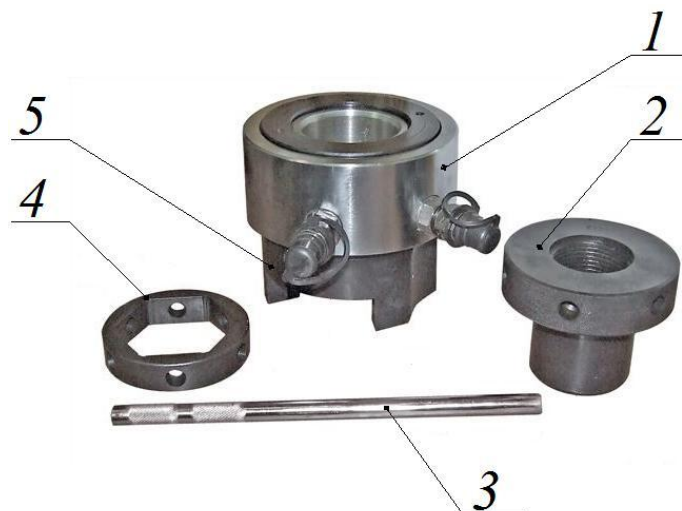
Рис.3 Состав домкрата гидравлического тензорного ДТГ30
