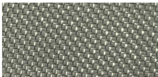
Фотография участка микрорельефной поверхности пленочного холодного катода. Увеличение 50\times .
