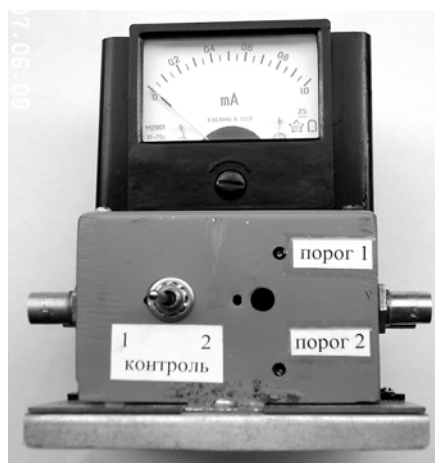
Рис. 4. Внешний вид двухканального формирователя наносекундных импульсов с измерителем уровня порогового напряжения
