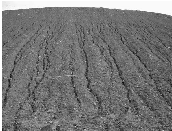
Рис. 4. Замер промоин на отвале шахты „Матросская”
