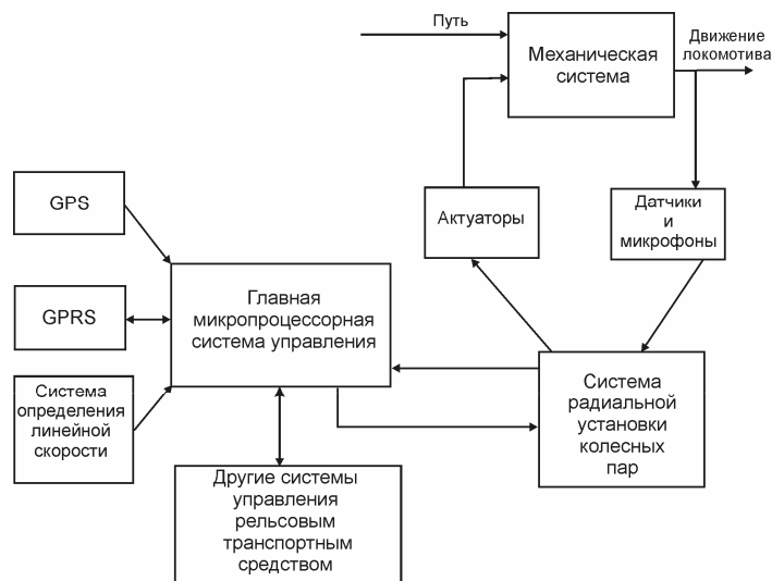
Рис. 6. Микропроцессорная система радиальной установки колесных пар
